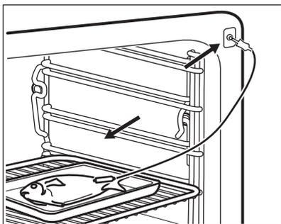
Introduisez la pointe de la sonde alimentaire exactement au centre de la cocotte. La sonde alimentaire doit être stabilisée en un seul endroit pendant la cuisson. Pour y parvenir, utilisez un ingrédient solide. Utilisez le rebord du plat de cuisson pour appuyer la poignée de silicone de la sonde alimentaire. La pointe de la sonde alimentaire ne doit pas toucher le fond du plat de cuisson. Recouvrez la sonde alimentaire avec les autres ingrédients.
